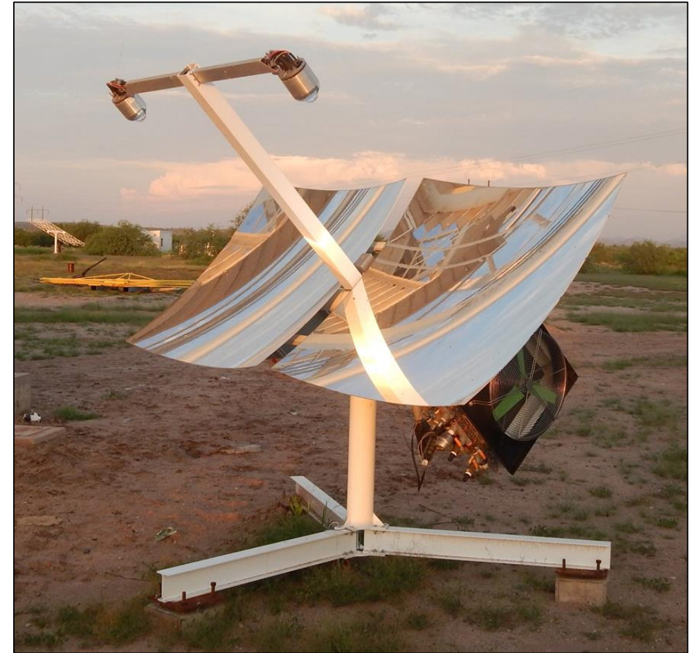
Figura 1 Sistema fotovoltaico de alta concentración 2M
