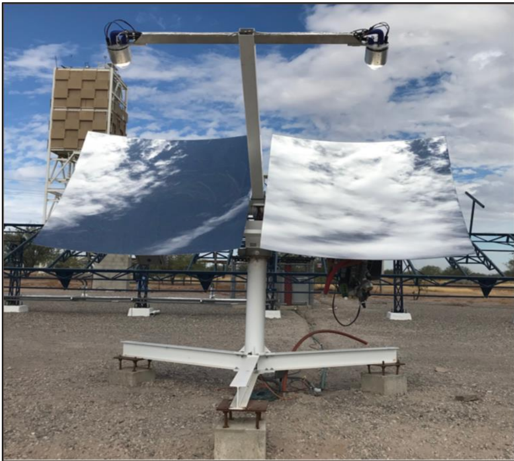
Figura 2 Sistema fotovoltaico de alta concentración 2M
